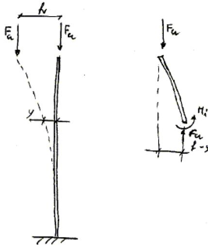
Figura 25: Pilastro soggetta a carico di punta (Column-Beam)
