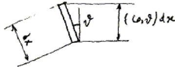
Figura 26: Rotazione di un concio nel pilastro soggetto a carico di punta
