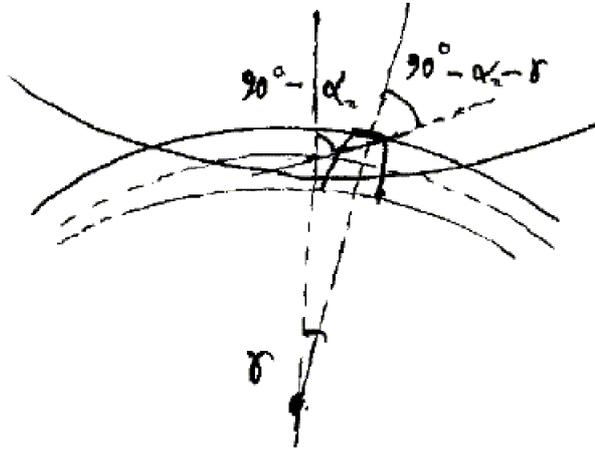
Figura 140: L'inclinazione tra forza trasmessa ed asse del dente risulta maggiore in condizione di incipiente ingranamento che in condizione di contatto centrale, e precisamente maggiore di un angolo  $\gamma$ , che costituisce anche la differenza  $\alpha_{an} - \alpha_n$ .
