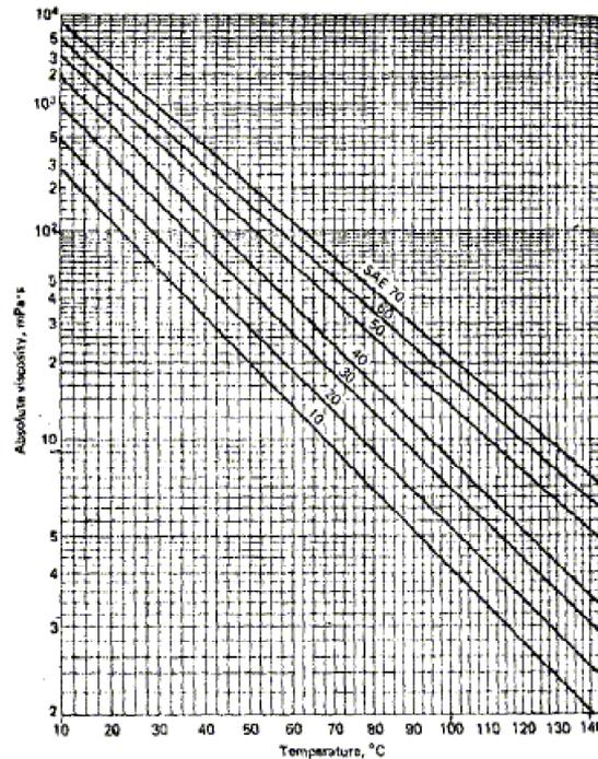
Figura 105: Variazione della viscosità dinamica con la temperatura per oli SAE
