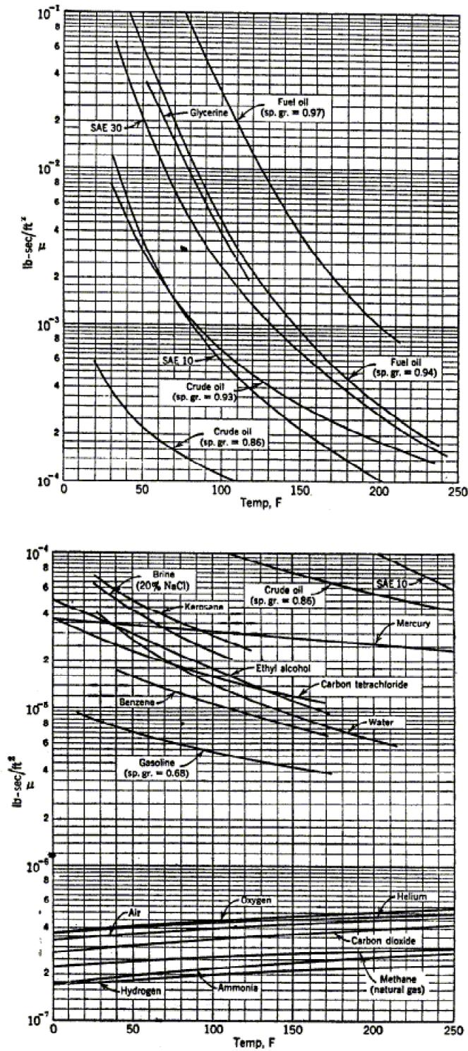
Figura 106: Viscosità dinamica in funzione della temperatura per vari fluidi. Per la conversione:
