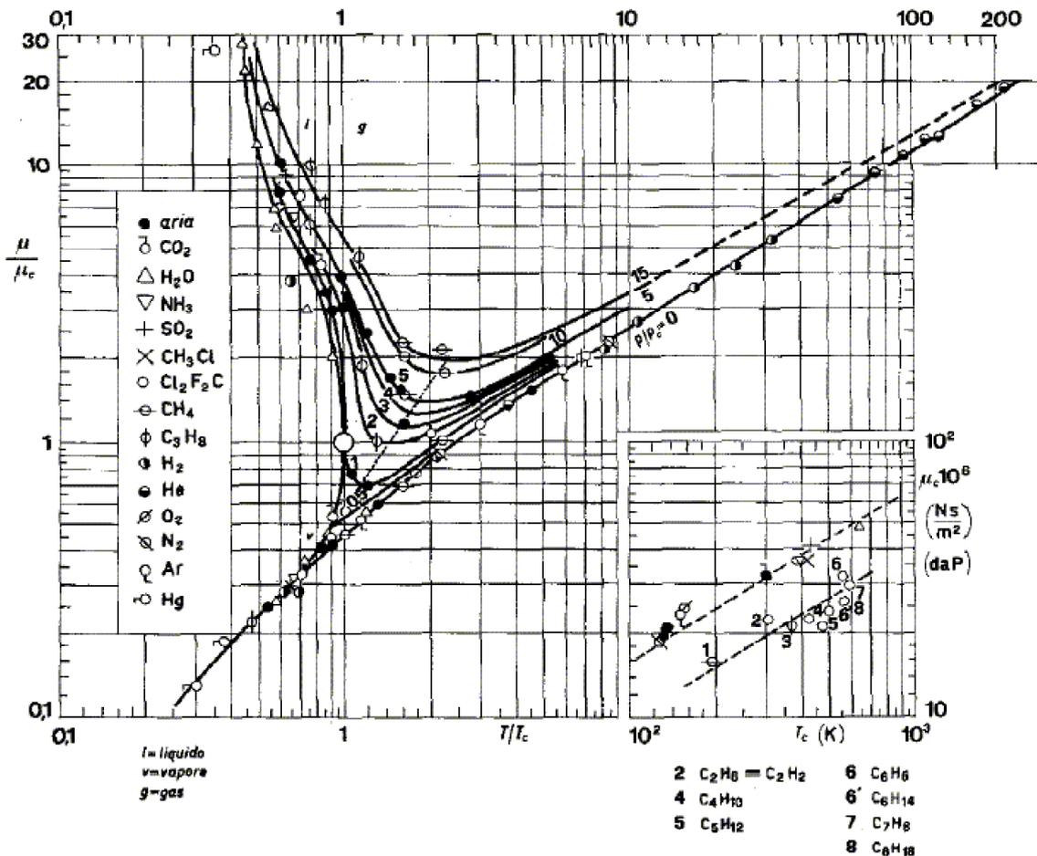
Figura 108: Viscosità dinamica in coordinate adimensionali. Da Codegone, C., *Atti Acc. Scienze*, Torino, 86, 1951-52, citato in *Enciclopedia dell'Ingegneria*, vol I, p. 2-260.
