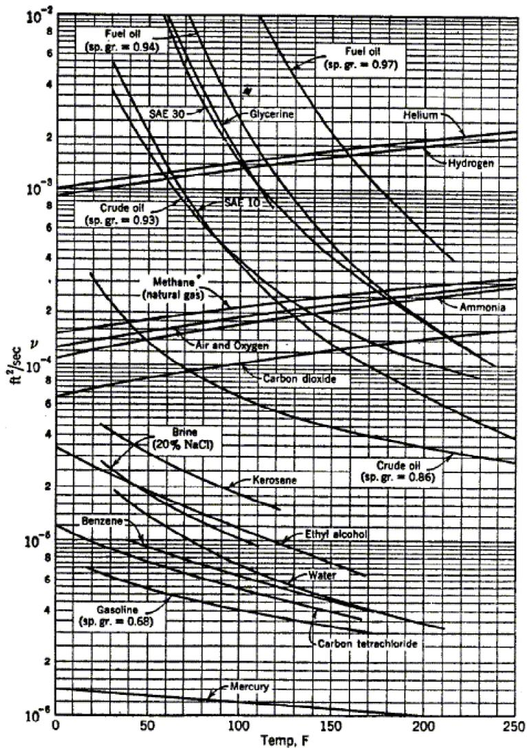
Figura 107: Viscosità cinematica in funzione della temperatura per vari fluidi
