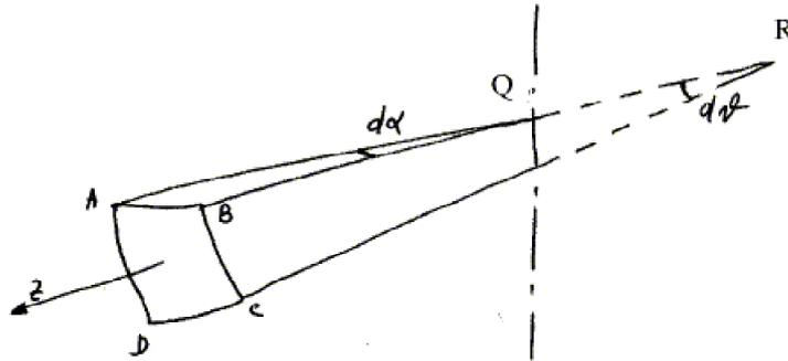
Figura 67: Elementino di superficie di rivoluzione, per ricavare l'equazione di Laplace.
