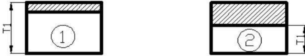
La tolleranza  $T_1$  è più piccola della tolleranza  $T_2$ , di conseguenza la lavorazione del particolare 1 è più accurata che nel particolare 2.
